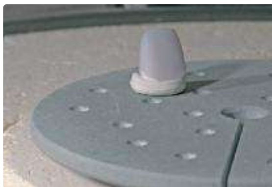
Posizionare il portaoggetti in forno ed effettuare la cristallizzazione con i relativi parametri.
