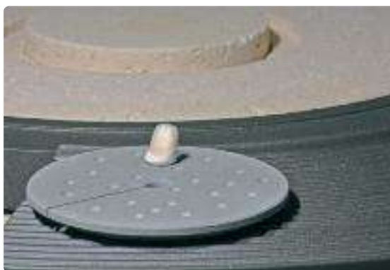
Dopo il decorso del programma di cristallizzazione, prelevare il portaoggetti dal forno e lasciare raffreddare il restauro IPS e.max CAD LT a temperatura ambiente.
