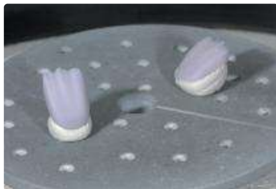
Posizionare il portaoggetti in forno ed effettuare la cristallizzazione con i relativi parametri.
