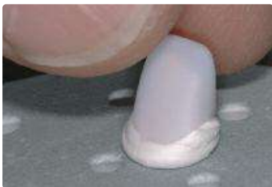
Posizionare il restauro sull'IPS e.max CAD Crystallization Tray.
