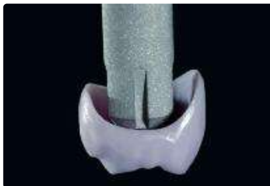
Scegliere il perno IPS e.max CAD Crystallization Pin della dimensione più grande possibile
