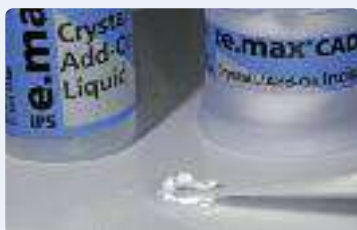
Miscelare IPS e.max CAD Crystll./Add-On con IPS e.max CAD Crystll./Add-On Liquid in una consistenza modellabile.
