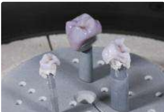
Posizionare il restauro al centro del portaoggetti IPS e.max CAD Crystallization Tray e cristallizzare con i parametri di cottura indicati
