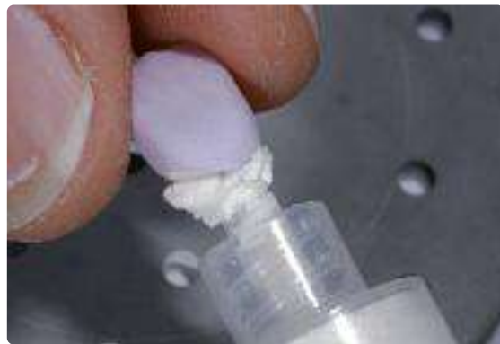
Riempire la cavità con IPS Object Fix Putty o Flow in leggera eccedenza.
