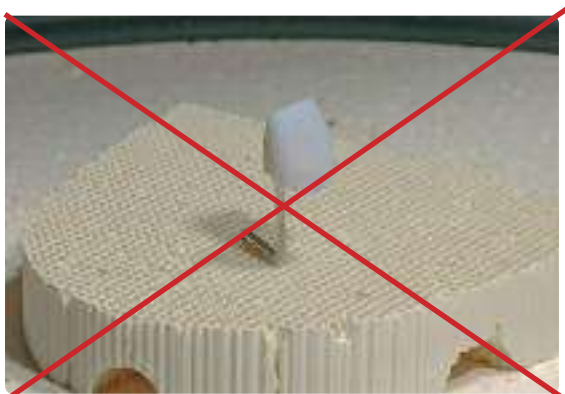
Non posizionare il restauro IPS e.max CAD su perni in metallo e non utilizzare portaoggetti a nido d'ape.
