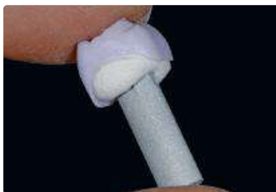
Premere IPS e.max CAD Crystallization Pin a fondo nella pasta IPS Object Fix Putty o Flow
