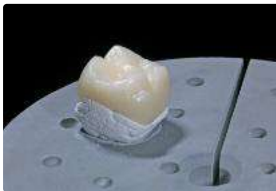
Al termine del programma di cristallizzazione prelevare il portaoggetti dal forno e lasciarlo raffreddare.
